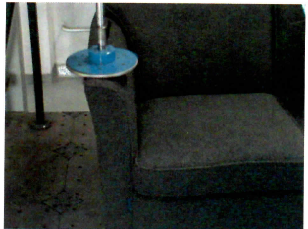
Fot. 11. Badanie statyczne obciążenia poręczy siłą skierowaną do dołu
