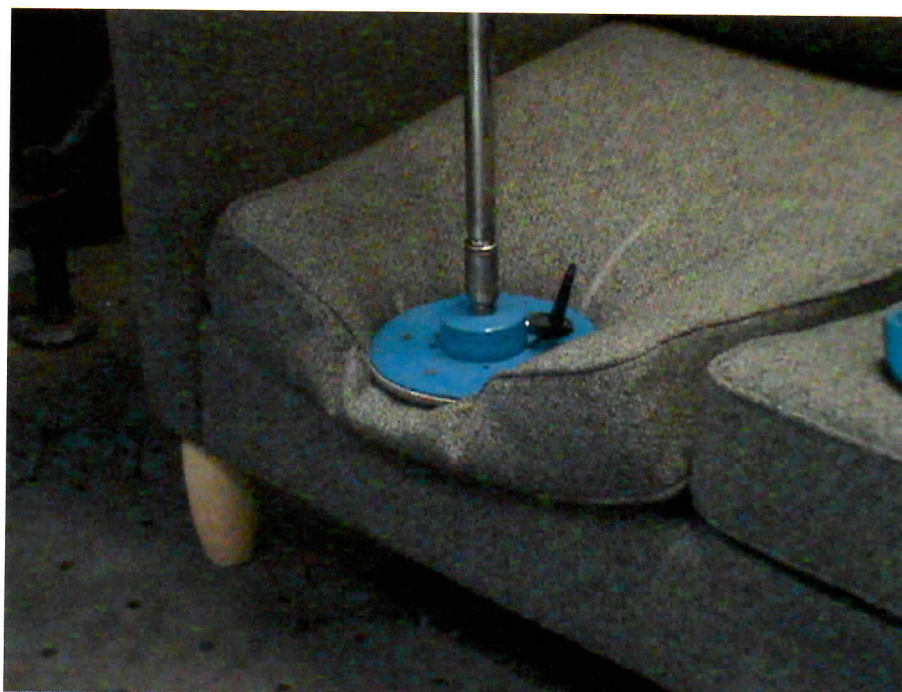
Fot. 4. Badanie statyczne obciążenia przedniej krawędzi siedziska
