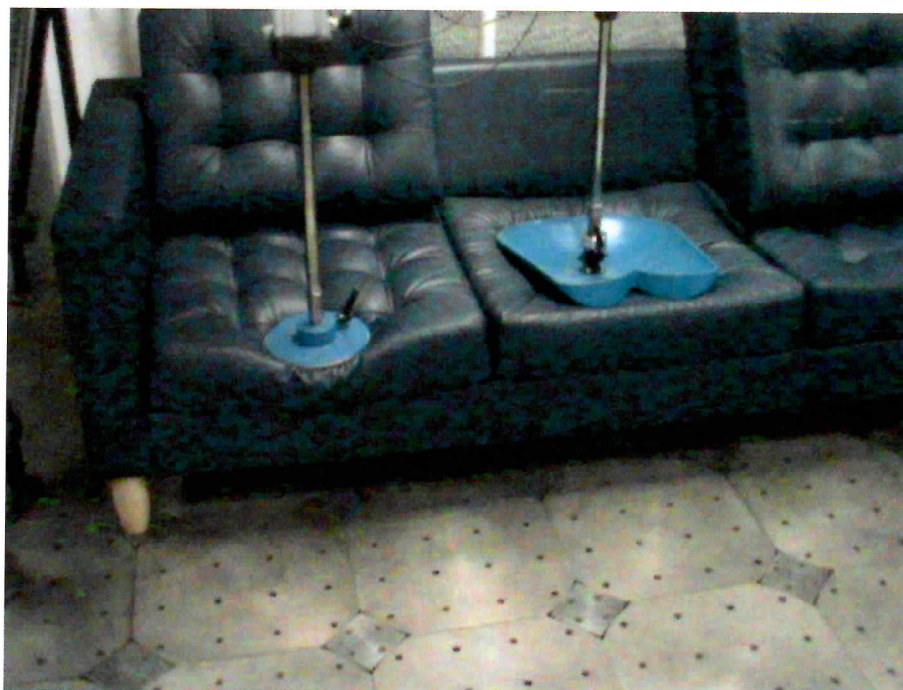
Fot. 15. Badanie statyczne obciążenia przedniej krawędzi siedziska
