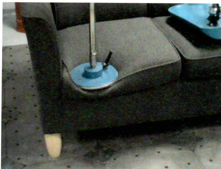
Fot. 9. Badanie statyczne obciążenia przedniej krawędzi siedziska
